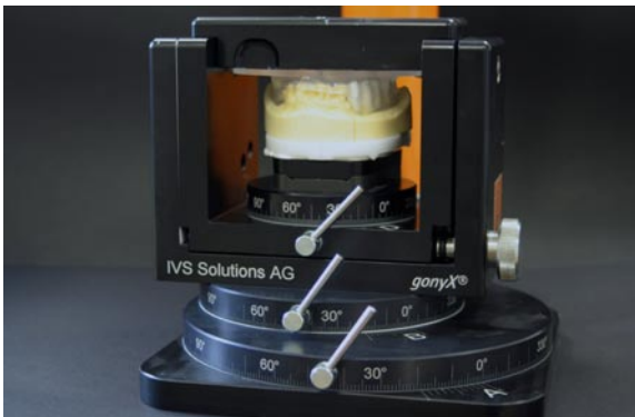
Abb. 3: Fixieren der Schiene im gonyX® in Nullebene.
