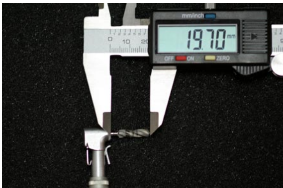
Abb. 8: Vermessen der Implantatbohrerlänge im chirurgischen Winkelstück.
