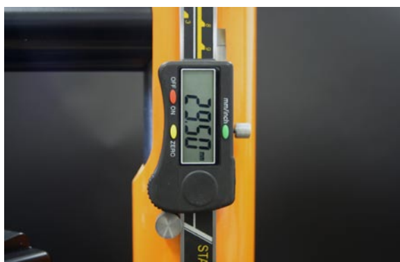
Abb. 13: Wert von der Nullebene bis zur Implantat Spitze als Tiefenanschlag.
